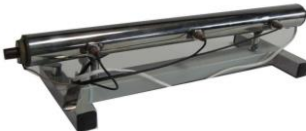
Рисунок 3 – Модуль НТЦ-22.05.1/3 «Исследование теплопередачи при естественной конвекции воздуха около горизонтального цилиндра»
