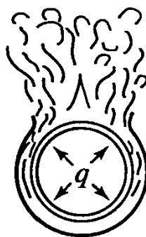
Рисунок 1 – Характер свободного движения воздуха около нагретой горизонтальной трубы
