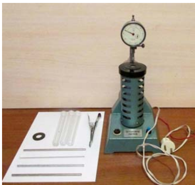
Рисунок 1 – Установка для измерения коэффициента линейного расширения
