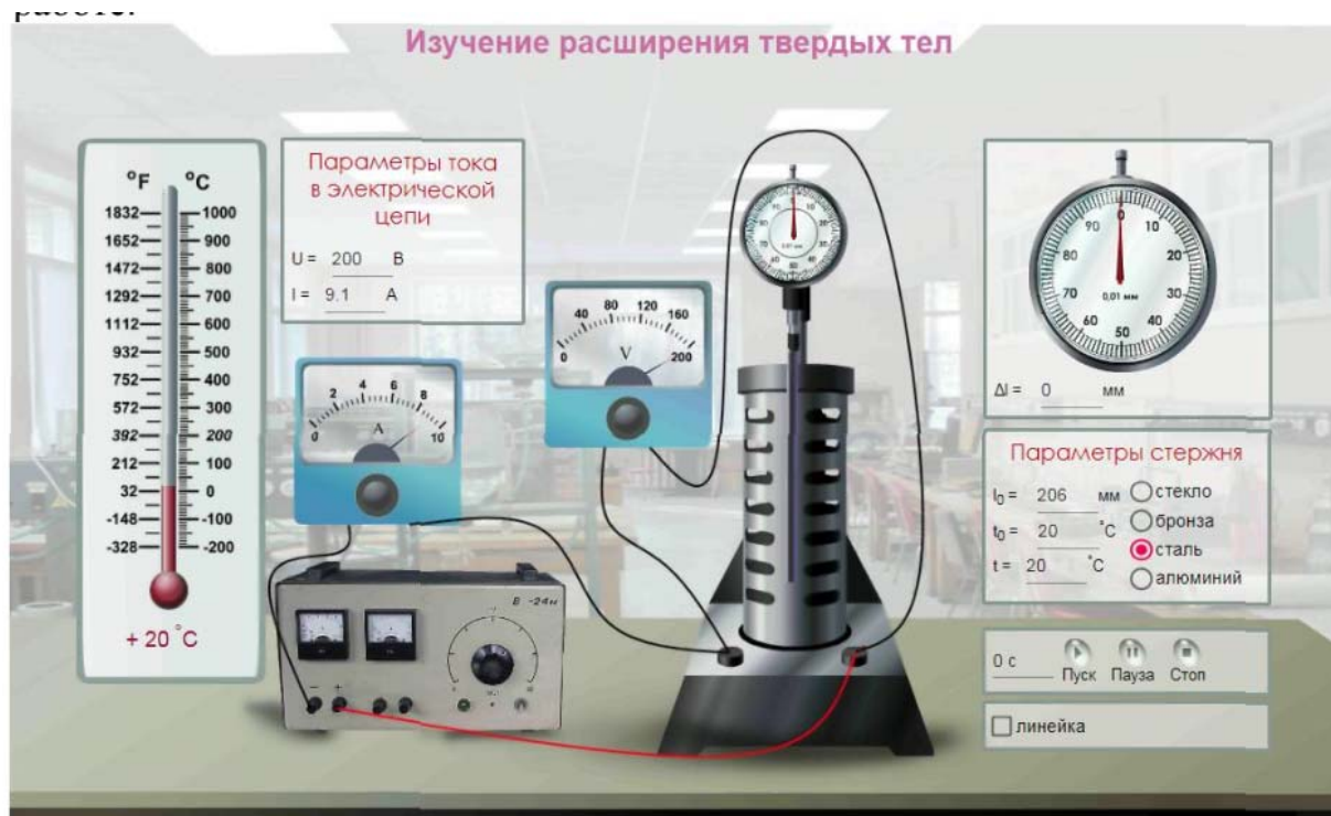
Рисунок 2 – Виртуальная интерактивная установка «Изучение расширения твердых тел»
