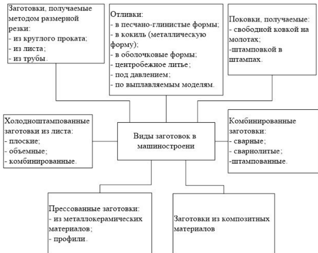
Рисунок 4.1 – Классификация методов и способов получения заготовок
