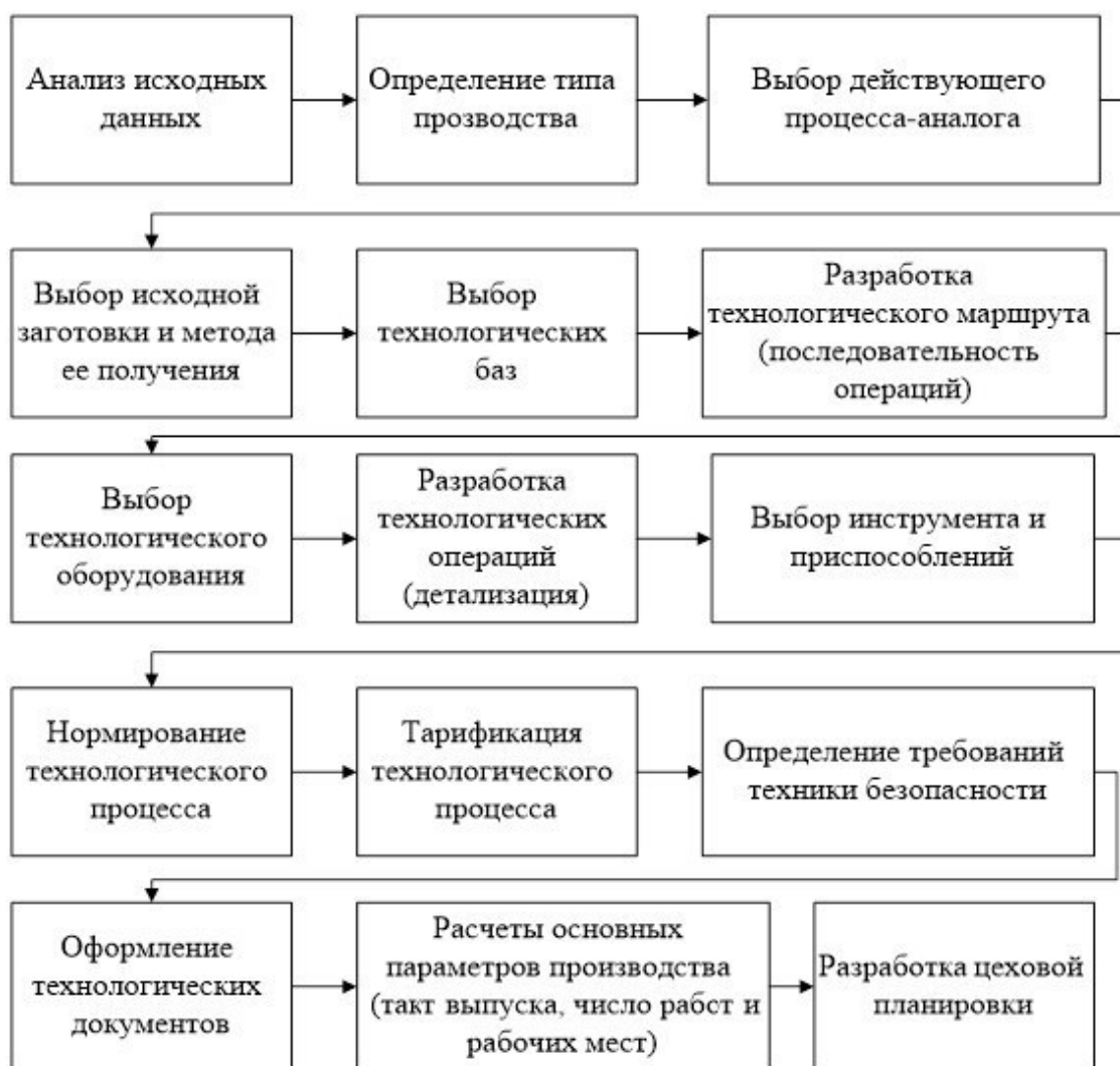
Рисунок 2.2 – Последовательность разработки технологического процесса изготовления изделия в соответствии с ГОСТ 14.301-83
