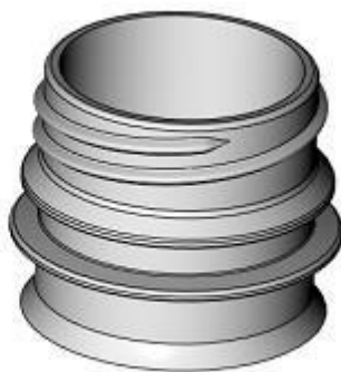
Рисунок 6.1 – Пример горлышка с резьбой
