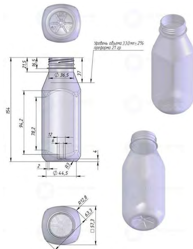
Рисунок 5.10 – Эскиз пластиковой бутылки с размерами
