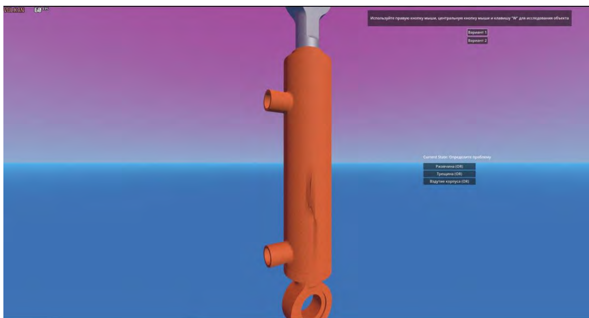
Рисунок 1 – Трехмерная модель поврежденного амортизатора в учебном симуляторе (увеличенный масштаб и угол просмотра)
