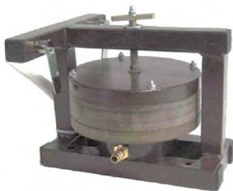
Рисунок 3 – Модуль НТЦ-22.05.1/1 для определения коэффициента теплопроводности методом пластины
