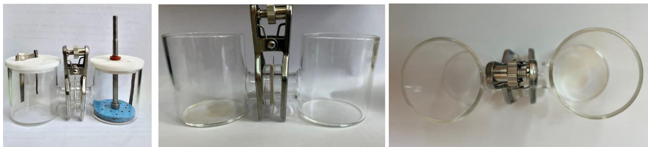
Рисунок 1 – Экспериментальная установка по получению феррата натрия (H-образная ячейка)
