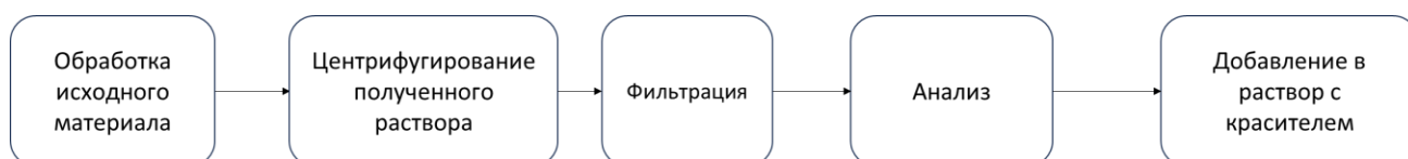
Рисунок 2 – Этапы проведения эксперимента по получению феррата натрия из железосодержащих отходов и окислению красителя
