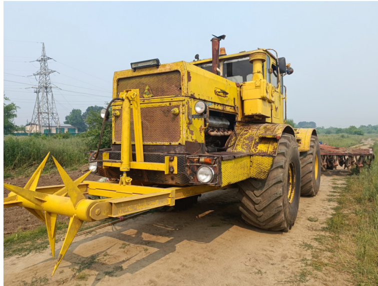
Рисунок 3 – Общий вид машинно-тракторного агрегата – трактор «Кировец» + БДМ-6х4 + устройство (фронтальный прокальватель-щелерез)
