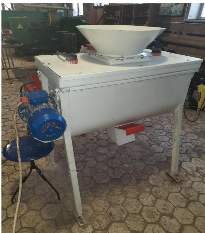
Рисунок 2 – Общий вид разработанного смесителя
