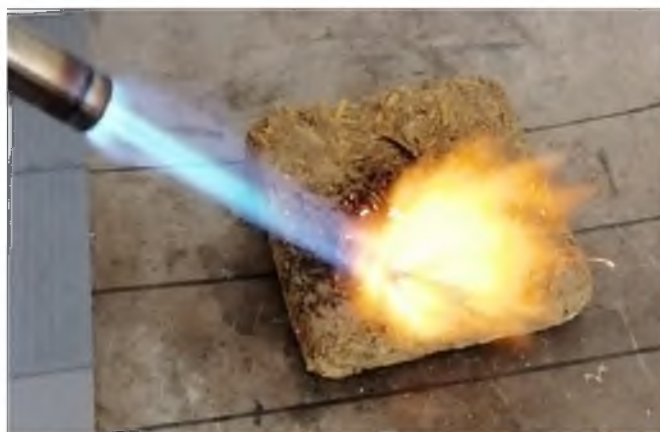
Рисунок 7 – Испытание на горючесть образца материала
