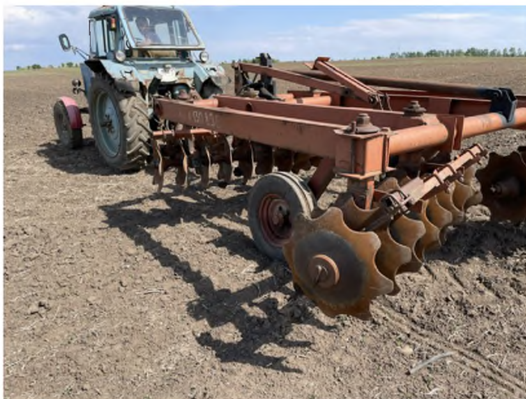
Рисунок 2 – Объект исследований МТА (трактор МТЗ 80+ дисковая борона БДТ-3)
