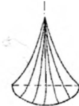
Рисунок 5 – Распределитель семян в виде сегмента с углом при вершине, переходящий к низу в криволинейные поверхности
