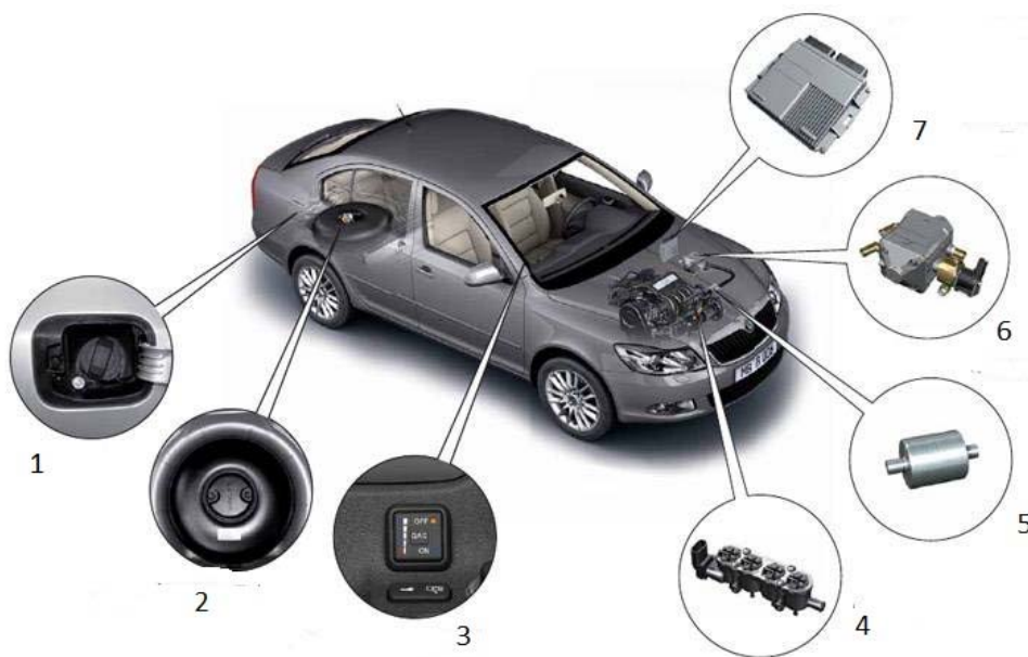
Рисунок 1 – Упрощенная схема четвертого поколения ГБО
