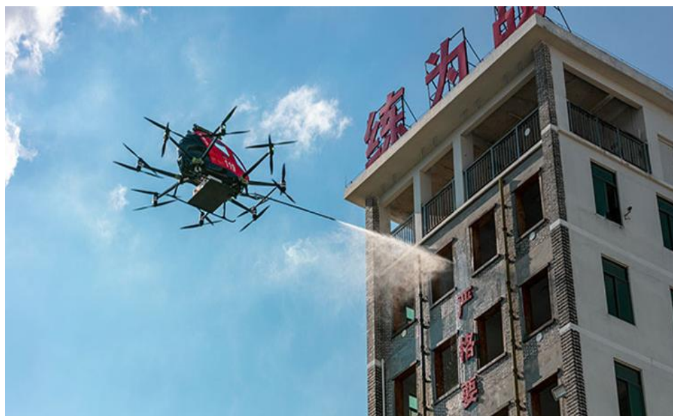
Рисунок – Тушение очага в высотном здании с применением дрона
