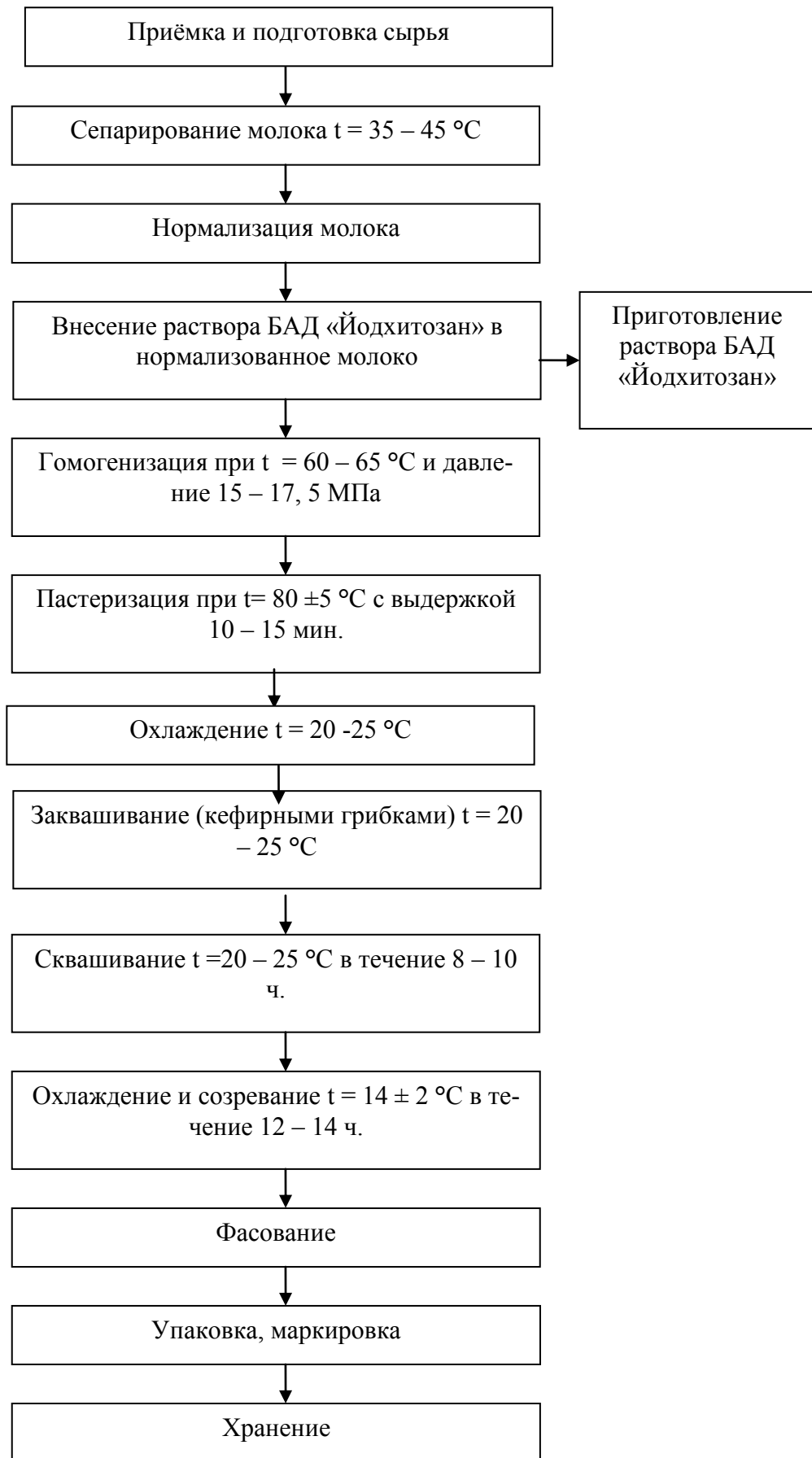
Рисунок – Технологическая схема производства кисломолочного напитка, обогащенного БАД «Йодхитозан»
