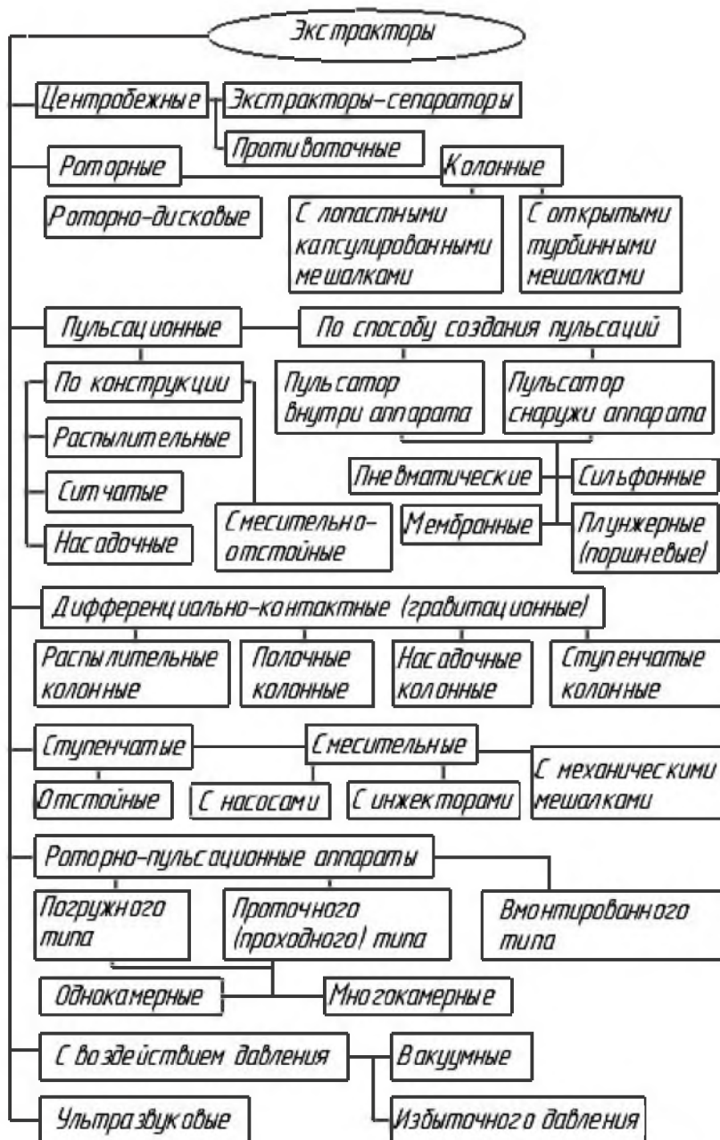
Рисунок 2 – Классификация экстракторов по конструктивным особенностям
