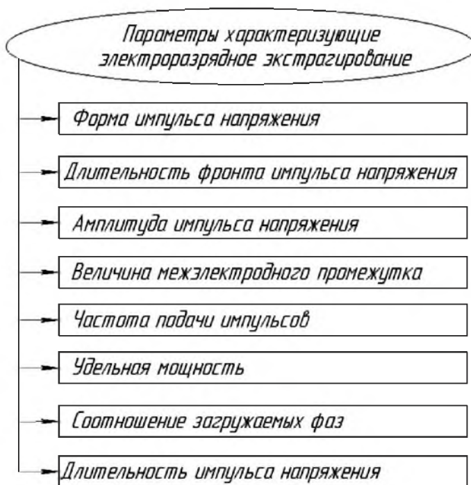
Рисунок 5 – Параметры, характеризующие электроразрядное экстрагирование
