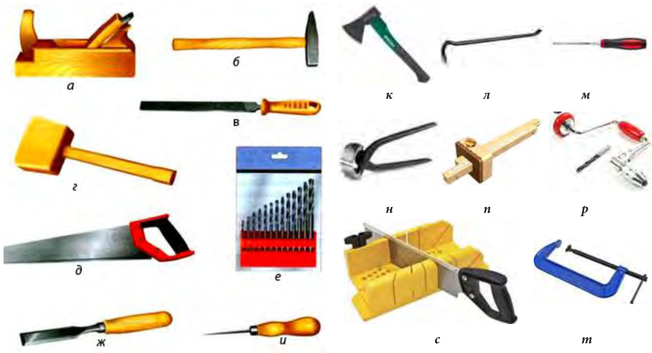
а – рубанок, б – молоток, в – напильник, г – киянка, д – ножовка, е – свёрла, ж – стамеска, и – шило, к – топор, л – гвоздодёр, м – долото, н – клещи, п – разметочный рейсмус, р – ручная дрель, с – стусло, т – струбцина Рисунок 17 – Инструменты для ручной обработки древесины
