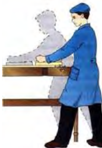
Рисунок 27 – Поза при строгании
