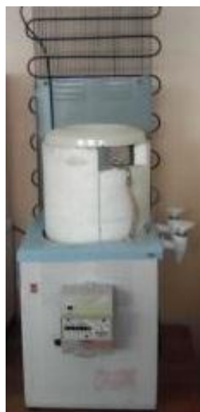
Рисунок 5 – Лабораторная установка для охлаждения жидкости
