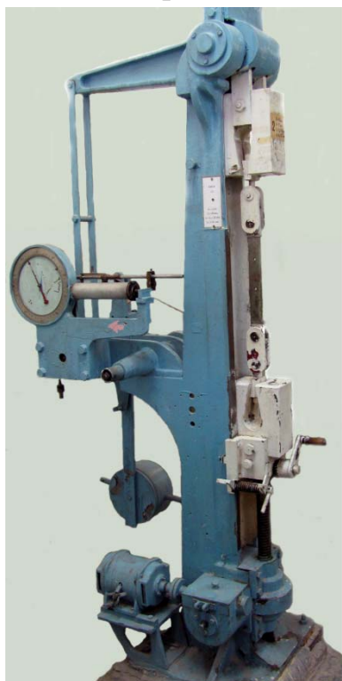
Рисунок 2.1 – Общий вид разрывной машины модели P-5
