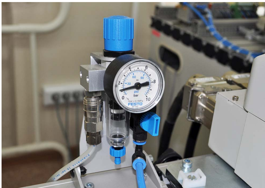
Рисунок 3 – Блока подготовки воздуха станции
