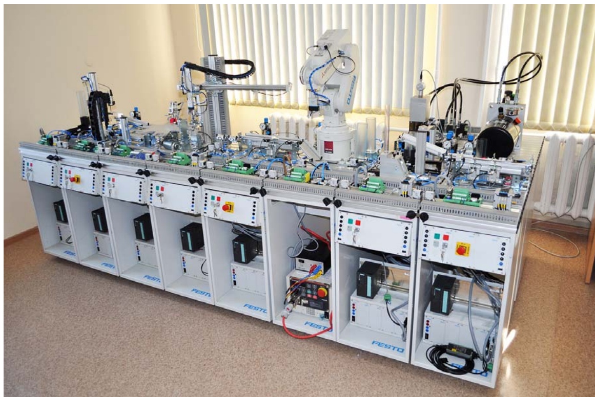
Рисунок 1– Автоматизированная модульная производственная система MPS210
