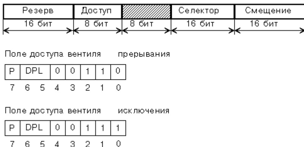
Рисунок 3 – Формат элементов дескрипторной таблицы прерываний IDT
