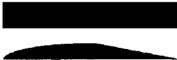
Рис. 1. Изменение формы пятна контакта с изменением износа ШК (сверху - неизношенный круг; внизу - круг с изношенной рабочей поверхностью)
