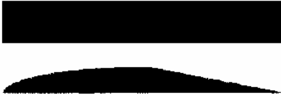
Рисунок 1 - Изменение формы пятна контакта с изменением износа ШК (сверху - неизношенный круг; внизу - круг с изношенной рабочей поверхностью).
