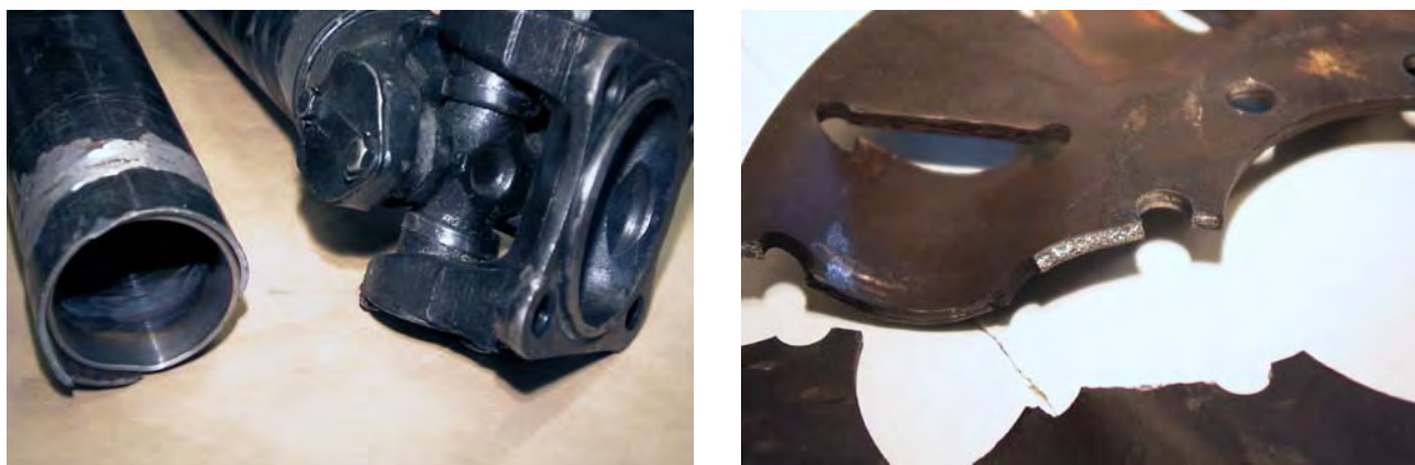
Рис. 1.9. Пример характерных разрушений деталей дотрансформаторной зоны трансмиссии
