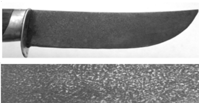
Рис. 7. Нож из волокнистого вутца (а) и сетчатый узор на его поверхности (б), \times 2 (изготовитель Ю. Г. Гуревич, 2000 г.)
