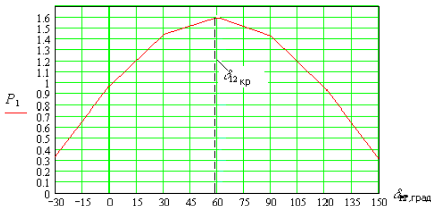
Рис.5 – Угловая характеристика мощности генератора
