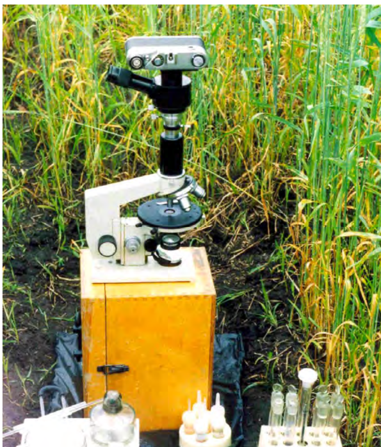
Рис. 39. Микрофотонасадка МФН-12 на микроскопе «Биолам» с фотокамерой «ФЭД»
