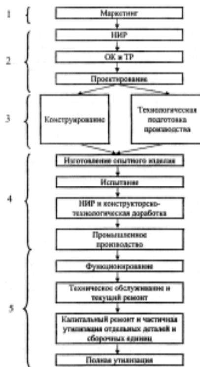
Рис. 1.2. Жизненный цикл машиностроительного изделия
