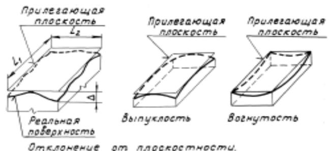
Рис. 6.2. Отклонение формы поверхности
