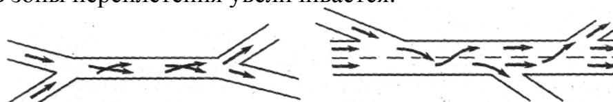
Рисунок 7.7 - Схема зон переплетения: а — простая; б — сложная
