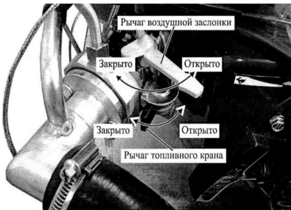
Рисунок 3.6 – Топливный кран и воздушная заслонка
