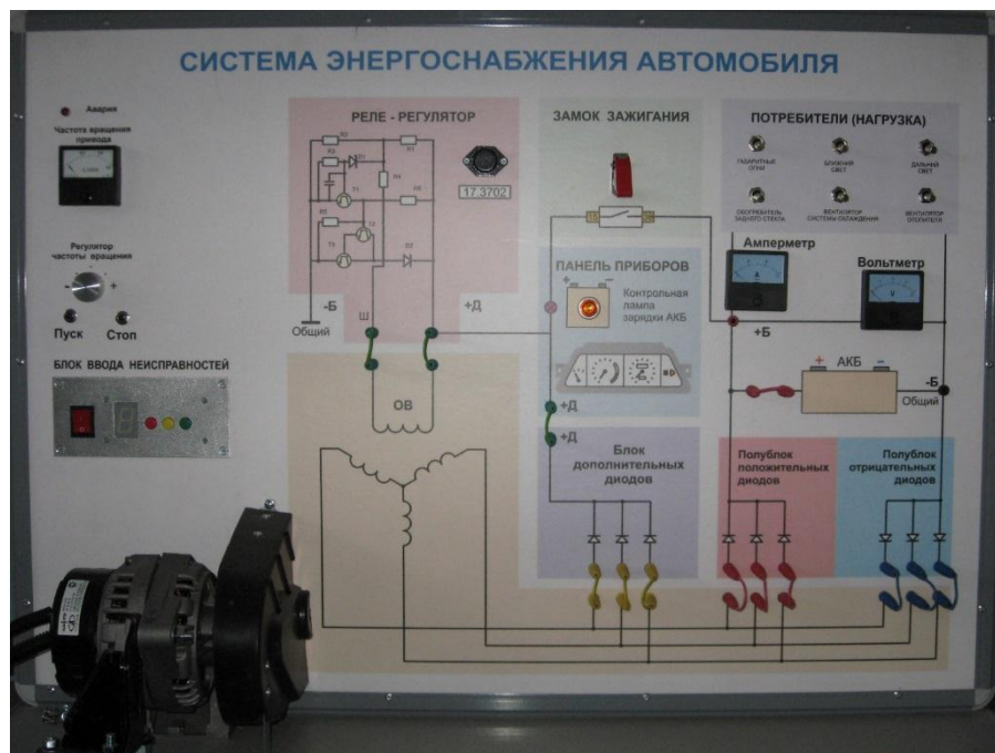
Рисунок 3 – Лабораторный стенд «Система энергоснабжения автомобиля», модель СЭСА.01
