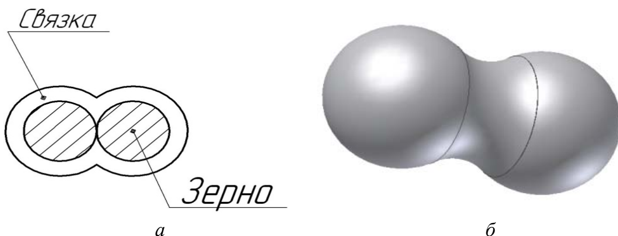
а – до расплавления связки; б – после спекания инструмента с образованными мостиками связки
