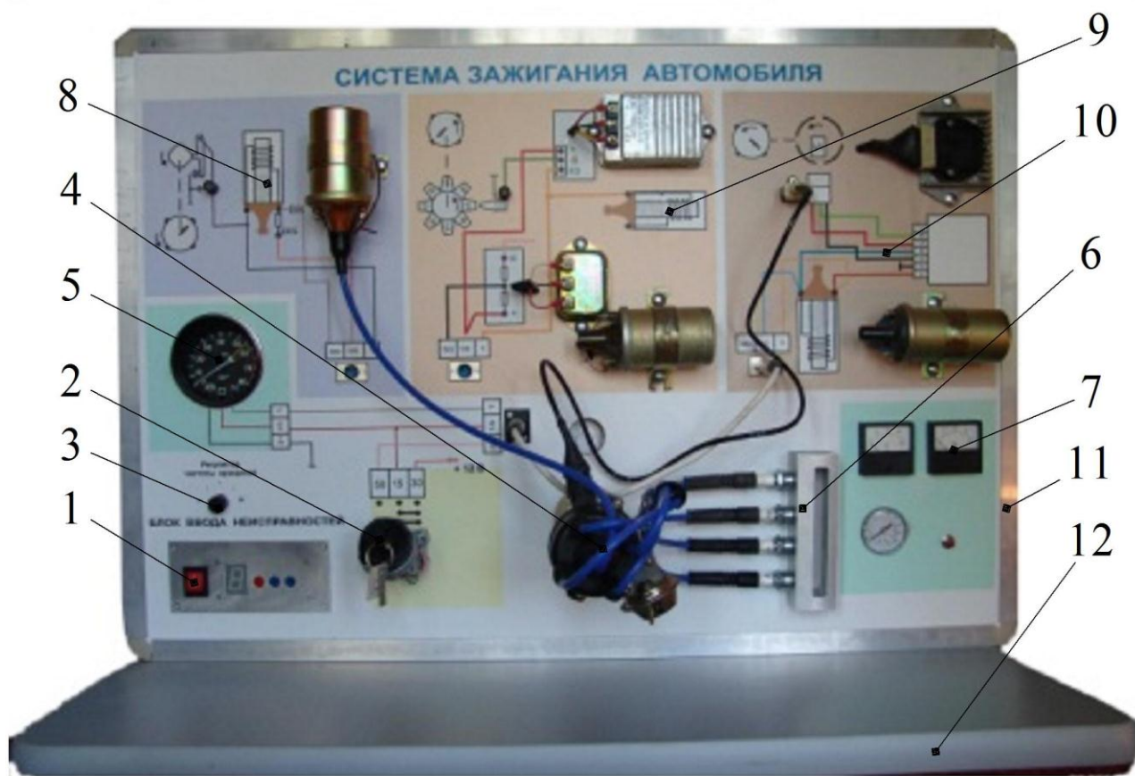
1) клавиша «Сеть»; 2) замок зажигания; 3) регулятор частоты вращения привода распределителей зажигания; 4) корпус привода распределителей зажигания; 5) тахометр; 6) камера для свечей зажигания; 7) панель контрольно-измерительных приборов; 8) блок-схема контактной системы зажигания; 9) блок-схема системы зажигания с индуктивным датчиком; 10) блок-схема системы зажигания с датчиком Холла; 11) основание стенда; 12) корпус Рисунок 3.1 – Стенд-тренажер «Система зажигания автомобилей»
