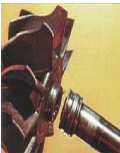
Рисунок 5.3 – Разрушение вала турбины из-за масляного голодания
