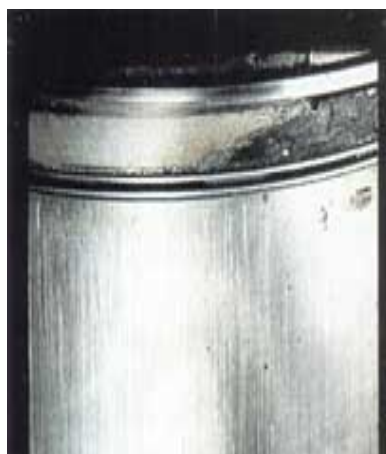
Рисунок 5.1 – Абразивный износ цилиндра под действием частиц, находящихся в моторном масле
