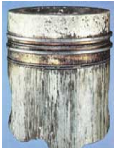
Рисунок 5.2 – Заклинивание поршня ввиду недостаточной смазки
