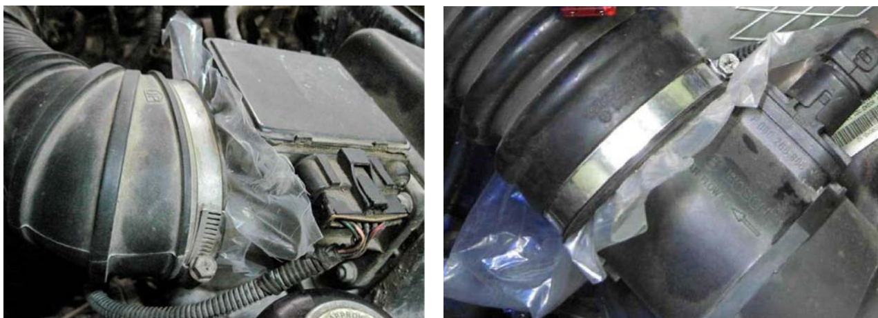
Рисунок 6.3 – Примеры перекрытия входного патрубка
