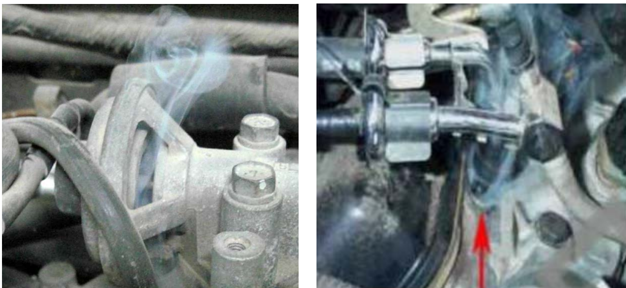
Рисунок 6.5 – Визуальное проявление негерметичностей вакуумной системы двигателя.
