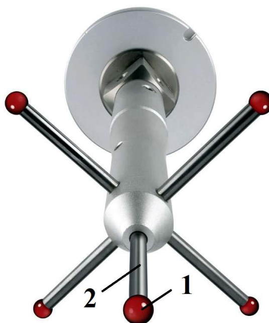
Рисунок 1 – Общий вид щуповой головки
