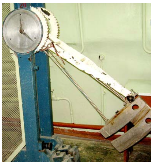
Рисунок 9 – Маятниковый копр и схема испытаний
