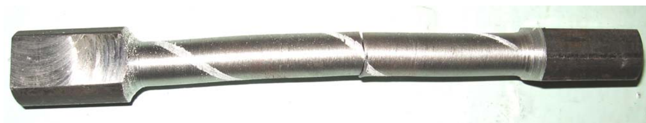
Рисунок 3 – Стальной образец до и после испытаний
