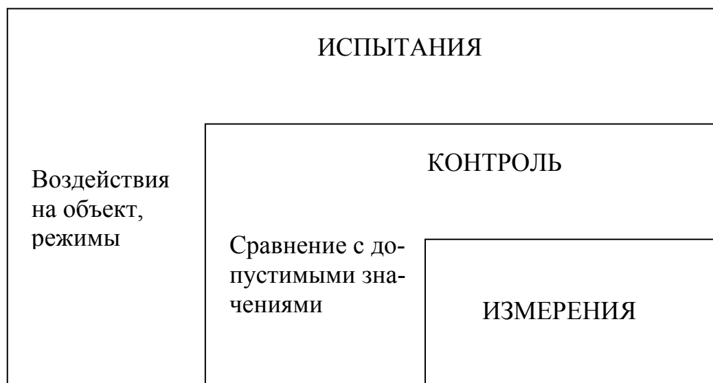
Рисунок 1 – Соотношение понятий «Испытания – Контроль – Измерения»
