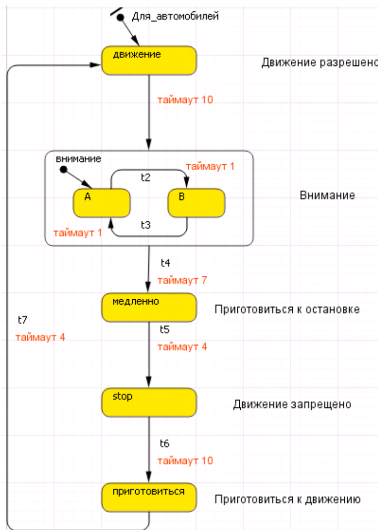
Рисунок 1.1 – Схема работы светофора
