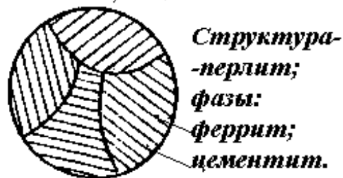
Сплав XI, C=0,8%
