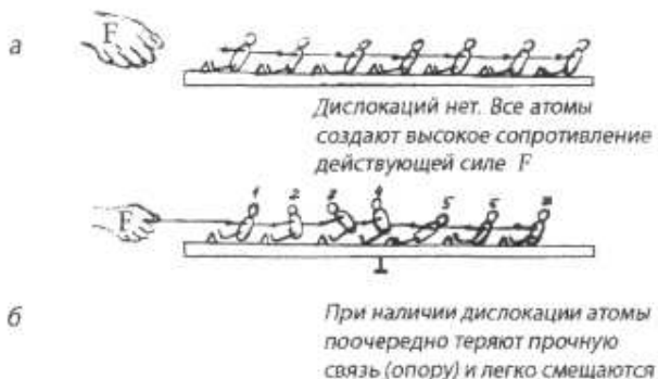
Рис. 10. Сопротивление действующей силы F монокристалла и поликристаллов реальных металлов: а - дислокаций нет, все атомы сопротивляются действующей силе F ; б - при наличии дислокаций атомы поочередно теряют прочную связь (опору) и смещаются
