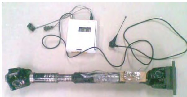
Рис.1. Образец приемопередающего бесконтактного устройства, установленный на объекте исследования
