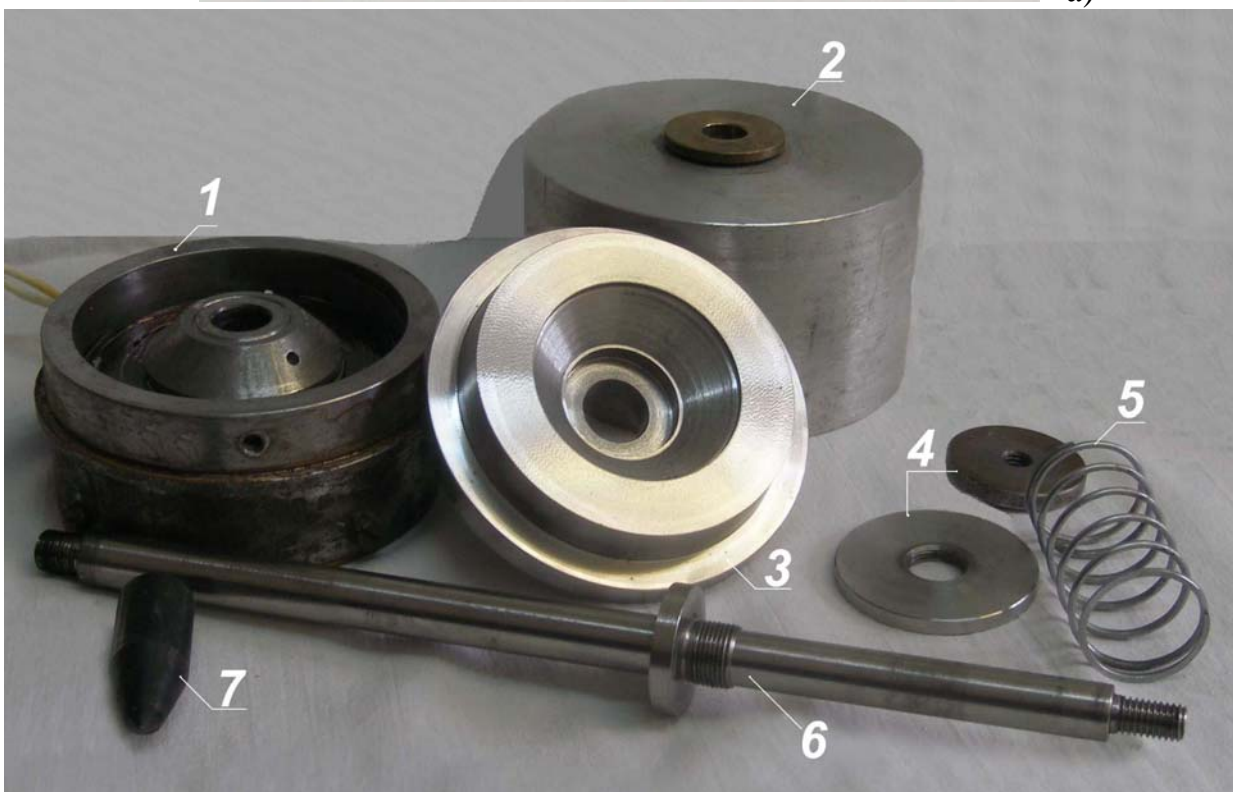
Рис. 2.12. Конструкция (а) и конструктивные элементы (б) ЛЭМД продольно-поперечного поля укороченной магнитной системы с конусно-усеченным полюсом и якорем: 1 – корпус МС с обмоткой возбуждения; 2 – крышка с направляющей; 3 – якорь; 4 – гайки; 5 – возвратная пружина; 6 – шток; 7 – клеймитель
