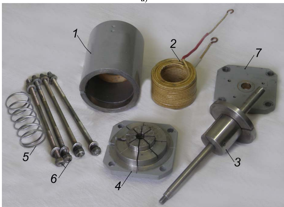
Рис. 2.11. Конструкция (а) и конструктивные элементы (б) ЛЭМД укороченной магнитной системы с комбинированным якорем и статором: 1 – корпус; 2 – обмотка возбуждения; 3 – якорь; 4 – фланец со стопом; 5 – возвратная пружина; 6 – шпильки; 7 – крышка с направляющей втулкой
