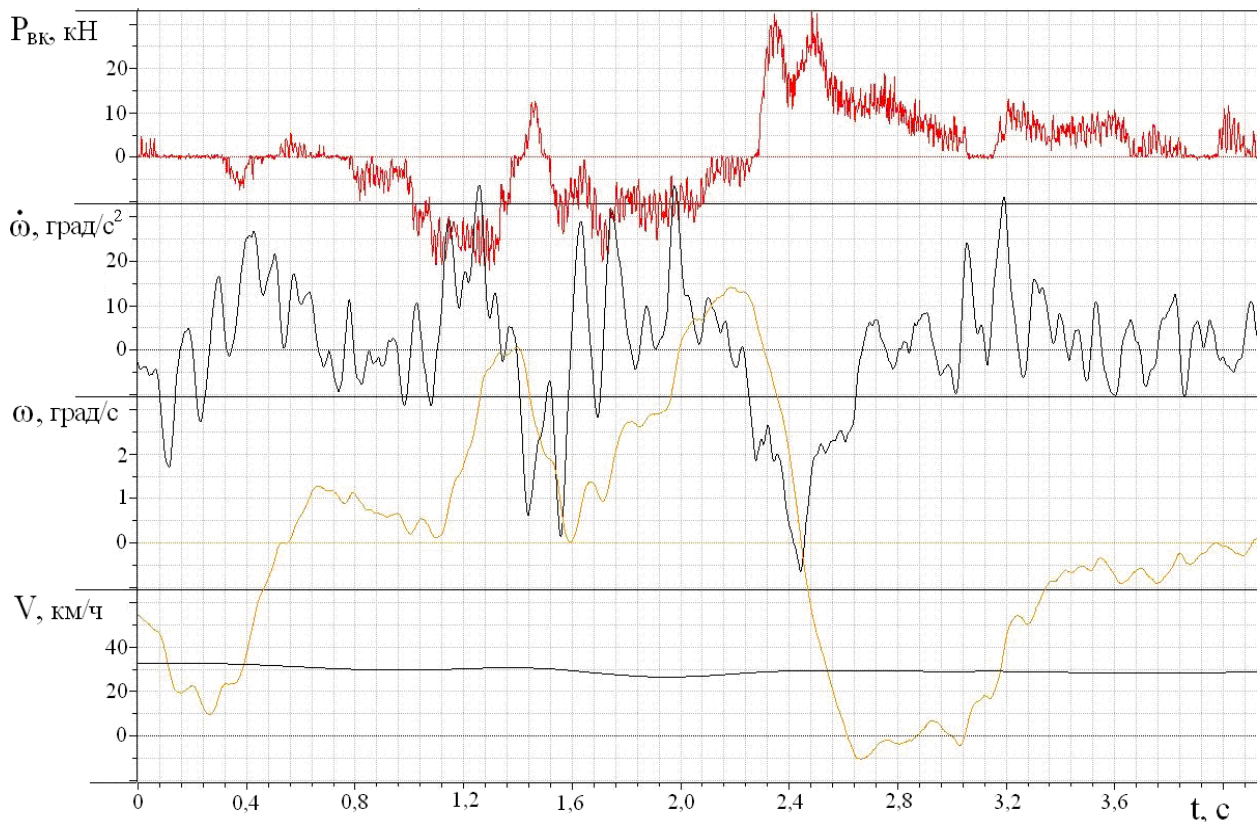
Рисунок 2.2 – Изменение параметров при движении гусеничной машины со ступенчатым механизмом поворота
