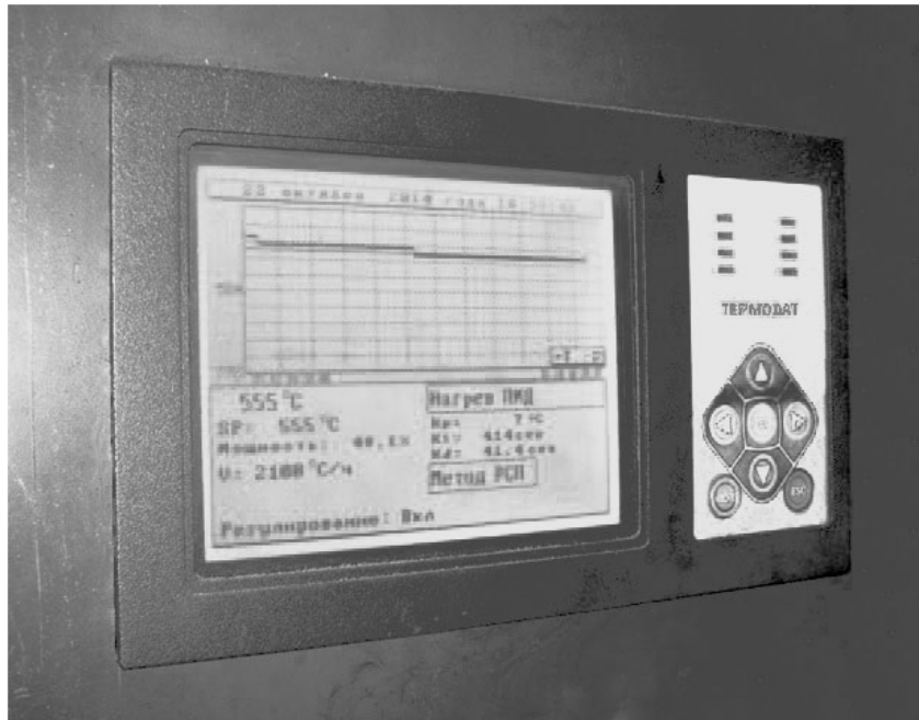
Рисунок 2 – Программный регулятор Термодат-16 на щите управления
