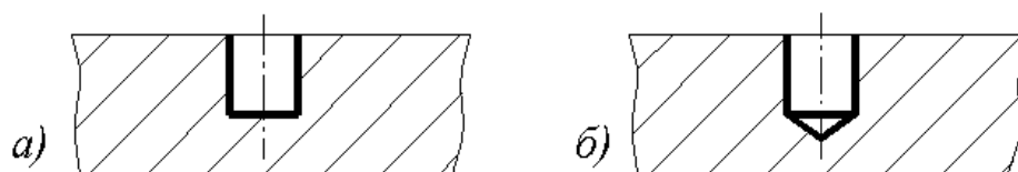
а – нетехнологичная; б – технологичная Рисунок 4.8 – Примеры конструкции детали с глухим отверстием
