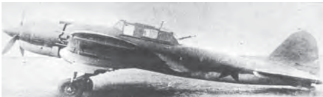
Рисунок 1 - Штурмовик ИЛ-2 с мотором АШ-82
