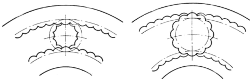
Рисунок 3.12 – Зубчатый подшипник с зацеплением Новикова (А.с. 125979)
