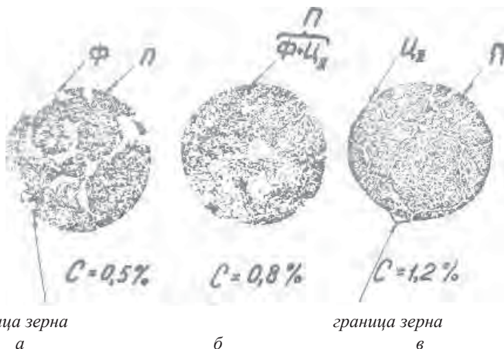
Рисунок В6 – Микроструктуры доэвтектоидной, эвтектоидной и заэвтектоидной сталей
